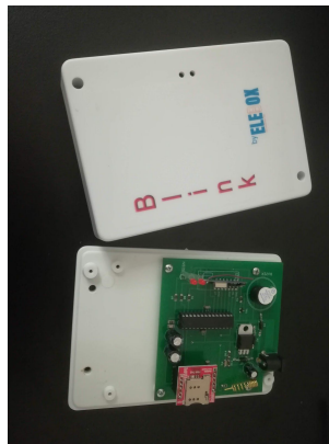
φ.2, φ.3 Τοποθέτηση sim κάρτας αφού βγάλουμε την συσκευή από την παροχή . Μετά κλείνουμε το κάλυμμα και την συνδέουμε στην τροφοδοσία.
